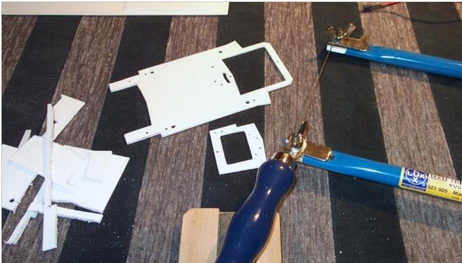
Polystyrol-Platten in 1,5mm und 1,0mm
